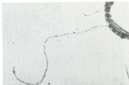
写真 3. 欠点糸のフィラメント切れ
