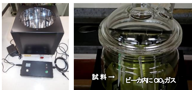
図1 バッチ式紫外線LED装置と処理の様子
