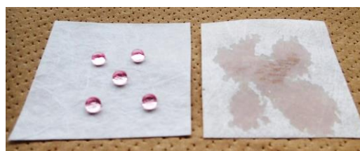
図6 PP不織布の水濡れ性向上の様子 (左：未処理，右：処理時間5分)
