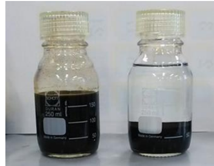
図5 一段階合成試料の外観 分散状態(左)と凝集状態(右)
