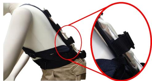
図8 アクチュエータ駆動ボーンの高剛性状態
