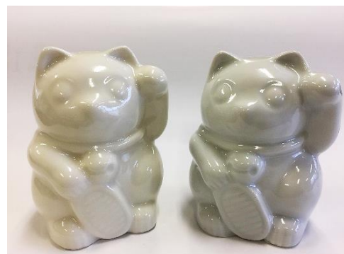
図5 鑄込み試作サンプル(SPS4ハイ土) 左;酸化焼成, 右;還元焼成
