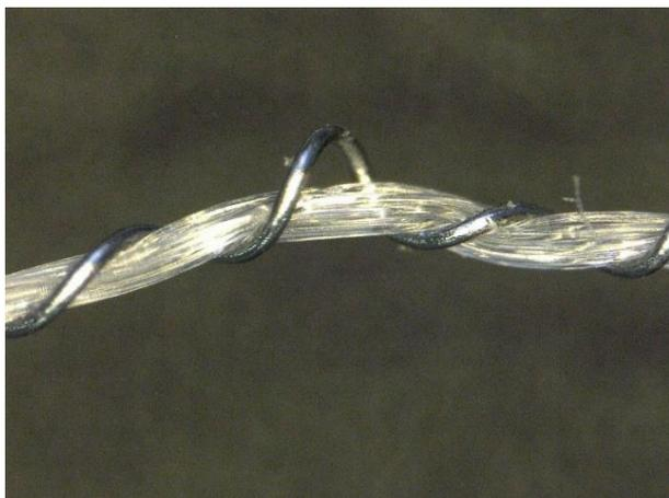
図8 繰り返し伸長試験後の糸の外観(150倍)
