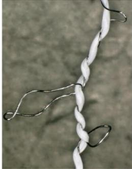
図2 芯糸ポリウレタン糸×鞘糸ステンレス糸の外観
