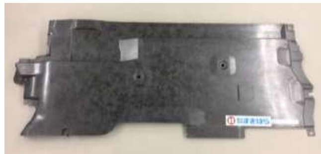
図5 ランダムシートから試作したアンダーカバー 上：表面、下：裏面
