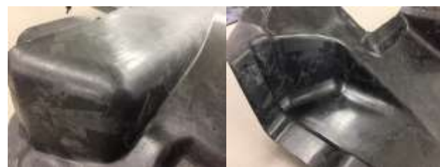
(a) 絞り形状部 (b) 段差形状部 図6 アンダーカバーの複雑形状部
