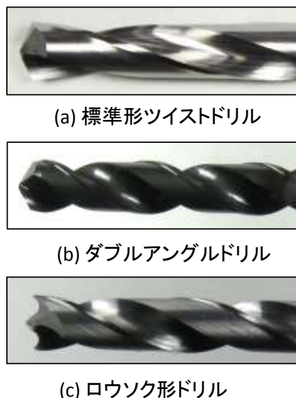
図2 実験に供した3種のドリル工具
