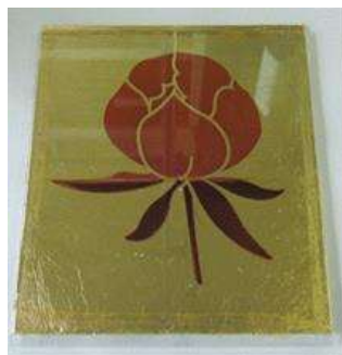
図6 金箔を用いた色素増感太陽電池(10cm角)
