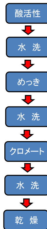
図3 めっき試作工程
