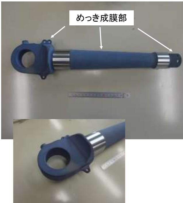
図5 航空機降着装置部品(ピン)への成膜
