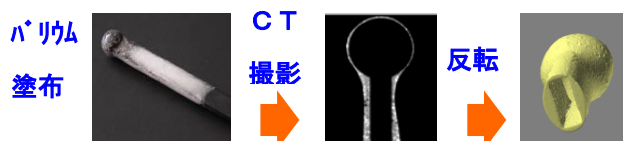
図2 造影可能な材料で覆いCTでデータ採取
