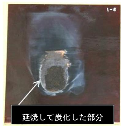
図 3 燃焼試験後の試料
