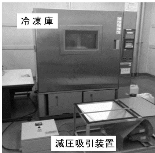
図2 凍結鑄型装置
