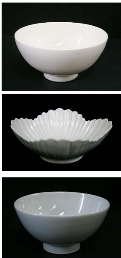
図3 製品試作品 上, 中: 酸化白色ハイ土 (上:ロクロ成形, 中:型打ち成形), 下:還元焼成用ハイ土(ロクロ成形)
