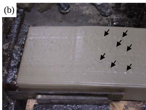
図8 カルシウム源の添加による製造ラインでの 押し出し成形時の様子 (a)消石灰5%, (b)石灰2.5%
