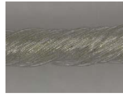
図3 ダブルカバリングによるコミングル糸
