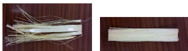
(a)ダブルカバリング 予備加熱無し (b)ダブルカバリング 300°C10分予備加熱 (c)エア混織 予備加熱無し (d)エア混織 300°C10分予備加熱
