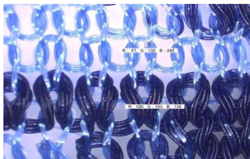
図3 染色した筒編み生地の拡大写真
