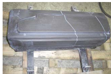
図5 型のき裂発生状況
