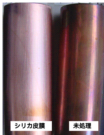
図11 塩水噴霧試験48時間後
