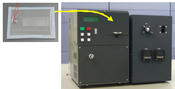
図 3 マイクロフロー型遺伝子検出チップ(写真左)と送液・温調用ユニット(写真右)
