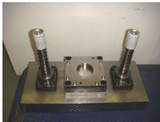
図 6 BN 膜をコーティングした絞り金型
