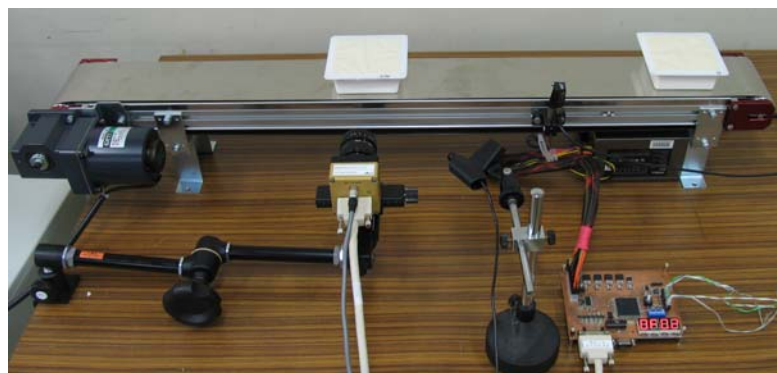
図 4 凝固検査用信号処理ボードの動作検証の様子
