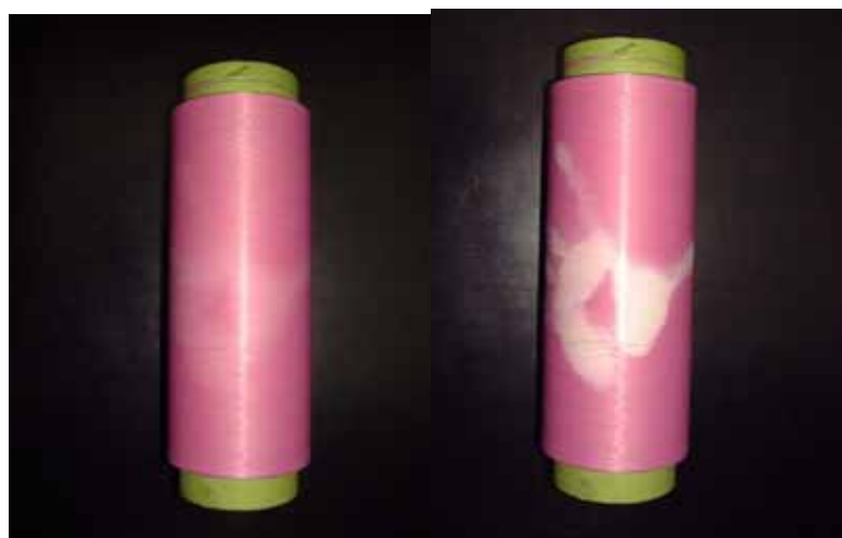
図5 感温色素剤ピンク25・2wt%含有させた感温繊維(手の温度で変化する)
