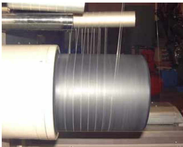
図4 熱ロールにおける糸斑による糸走行の不安定状態
