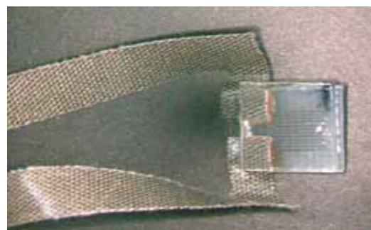
図3 作製した温度センサ部
