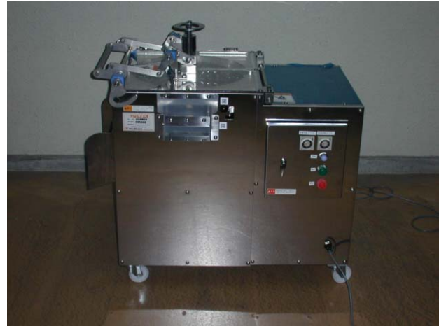
図7 鬼皮むき機(2号機)
