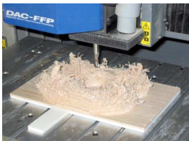
図2 桐材の荒加工
