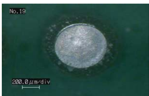
図8 はんだボールのマイクロ스코ープ像
