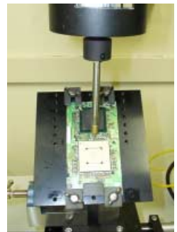
図3 リードプル強さ試験の概略
