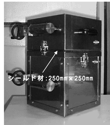
図2 SE測定用シールドボックス
