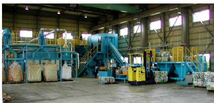
図11 小松市にできたペットボトルリサイクルセンター (上：外観，下：内部の様子)
