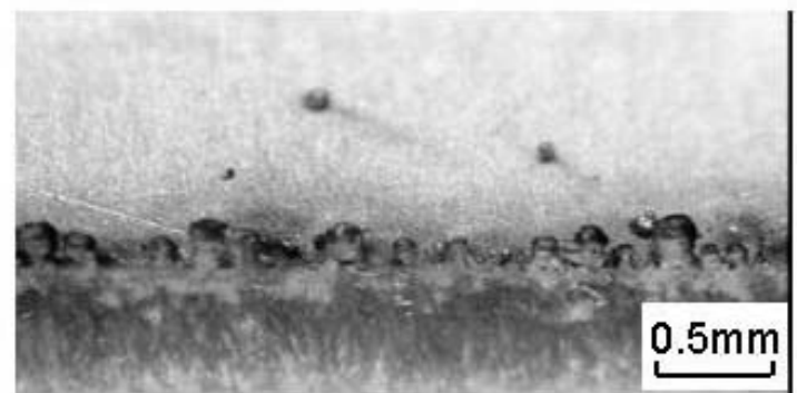
図10 SUS304材の切断部裏側エッジ
