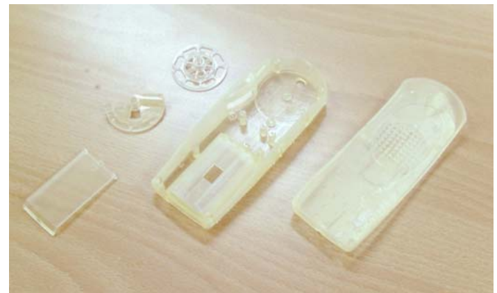
図7 光造形機による原型モデル
