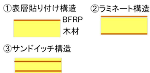
図3 BFRP/木材の積層パターン
