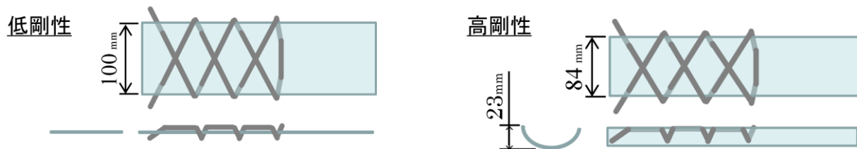
図3 試作ボーン（エアアクチュエータ駆動）
