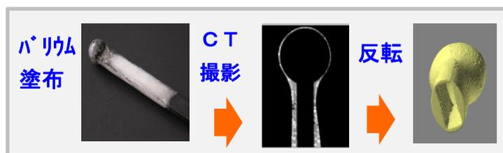
図3 造影可能な材料で覆いCTでデータ採取
