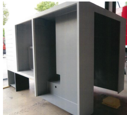
図2 GFRP製モノコック構造（車体）
