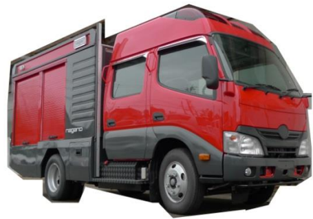
図1 GFRP製軽量型消防車両
