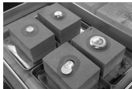
図 5 注湯直後の鑄型の様子
