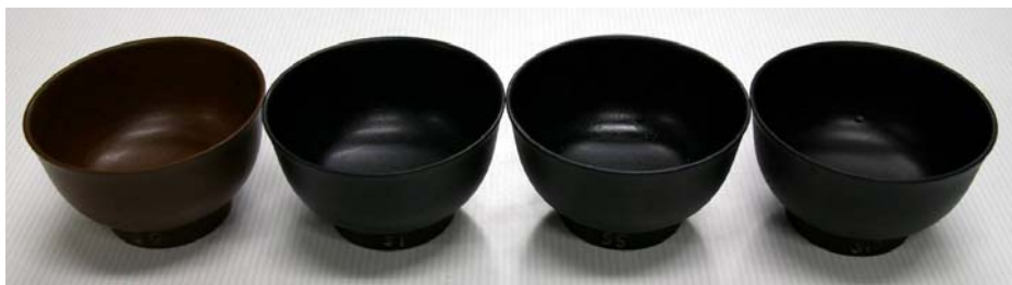
図5 ZnOナノ粒子添加漆塗り椀を1000回洗浄後の写真 (左から添加量 0%, 1%, 5%, 10%)
