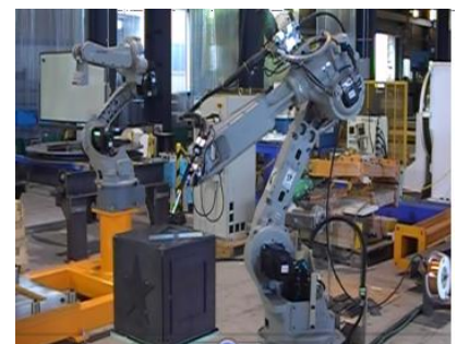
図3 開発システムによる溶接
