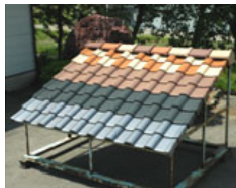
洋風瓦の施工モデル
