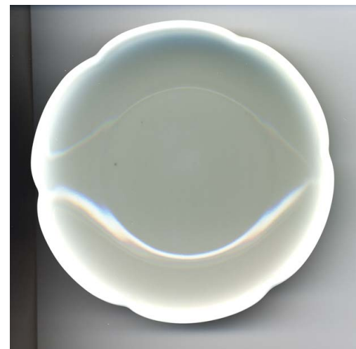
図3 貫入試験結果 鑄込み素地上：22.4wt%、下：3.0wt%
