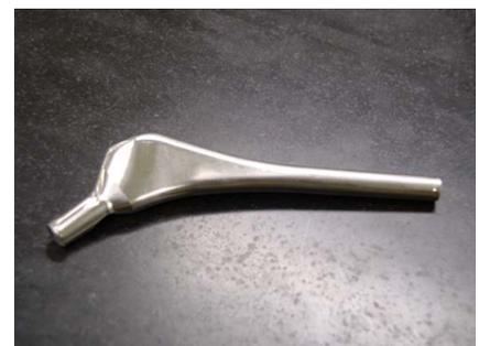
図4 人工股関節ステムの高速ミーリング加工
