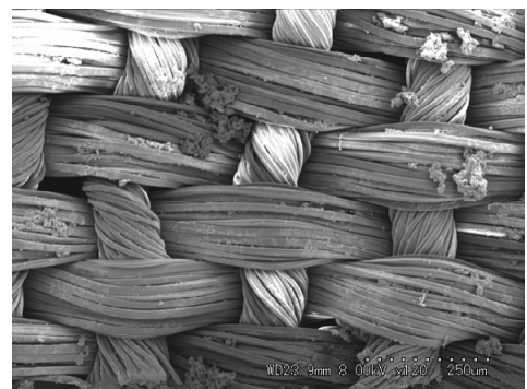
図4 予備加熱しながら発色した試料表面の拡大写真
