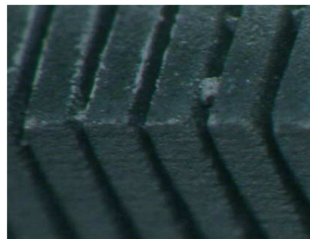
粒度:#2000, 集中度:130 気孔率:58%, 厚さ:3mm
