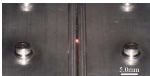
図3 半導体レーザーによる50 \mu m厚ステンレス鋼箔の溶接中の様子 (出力100W、速度275mm/sec)
