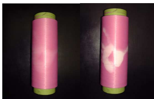
図3 a)変化前 b)変化後 感温繊維（手の温度で変化する）
