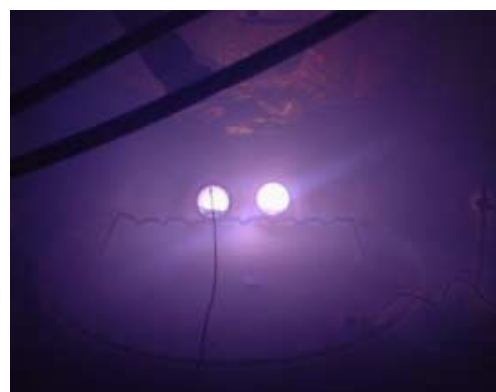
図2 パイプ内面へのコーティング
