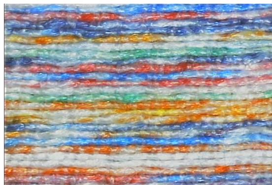
図6 試作した糸を用いて製織した織物表面
