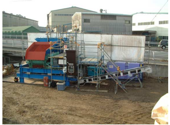
改良対象土と安定材とを混合する施工機械 (土質改良機－HAR-III－バッチ式)－写真②
