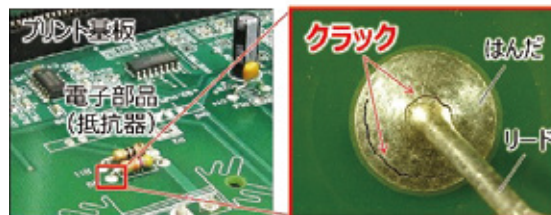
図2 加速試験後のはんだに発生したクラック
