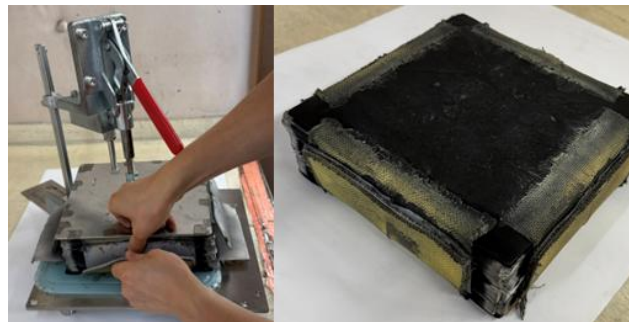
図 高強度のアラミド繊維による箔打ち紙の結束
