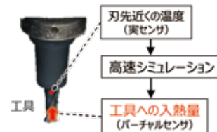
図2 工具への入熱量推定
